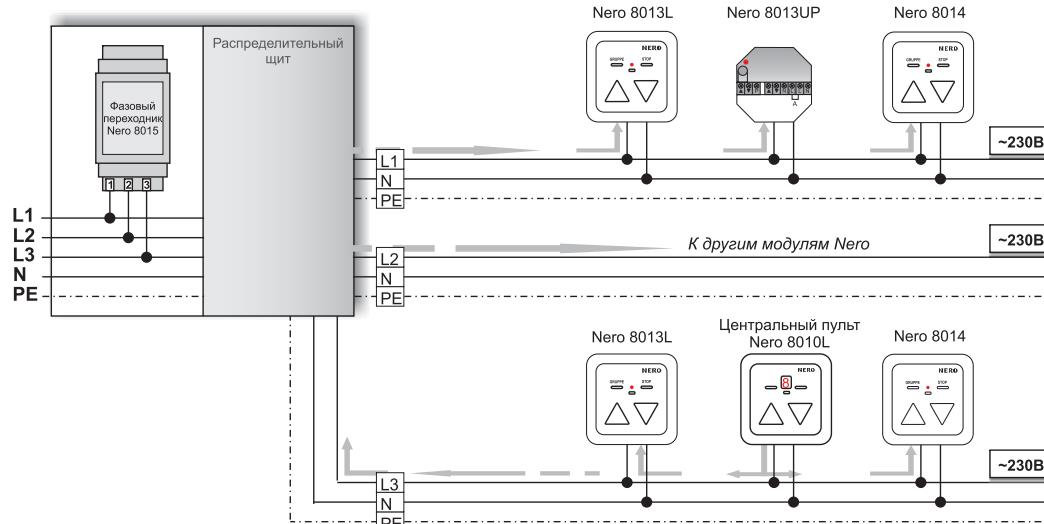
После монтажа фазового переходника в электрораспределительный щит обеспечивается надежная связь между всеми модулями системы, например, между несколькими исполнительными устройствами Nero, объединенными в одну группу управления, но подключенными к разным «фазам» сети 230В.
